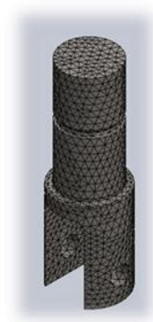
Figura 42 – Representação esquemática da malha utilizada na optimização do actuador
