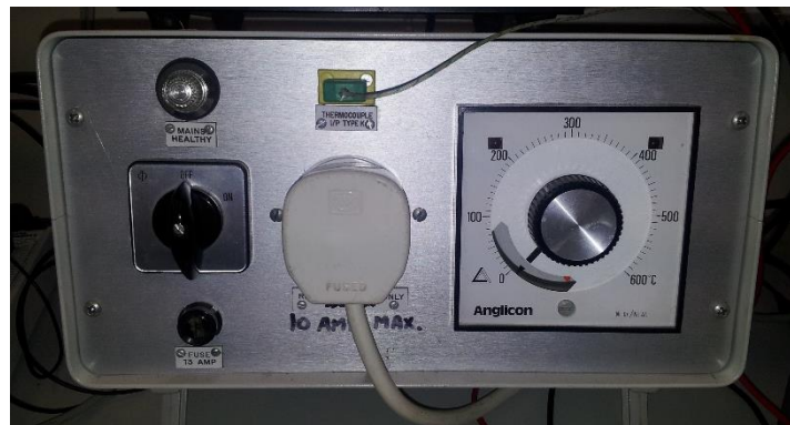
Figura 22 - Controlador de temperatura Anglison
