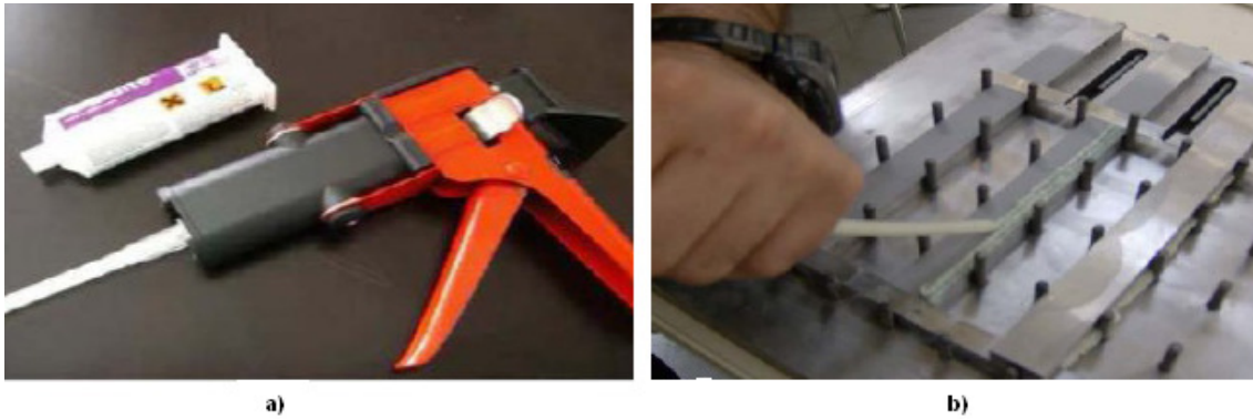
Figura 22 – a) Cartucho do adesivo Araldite 2015 e pistola de aplicação. b) Aplicação do adesivo Araldite 2015 nos substratos.
