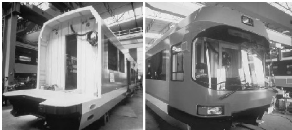
Figura 4 -Os comboios modernos são uma combinação de vidro, plásticos e metais leves ligados com adesivos a) carroçaria do comboio b) cabine ligada com adesivos à carroçaria do comboio. [1]
