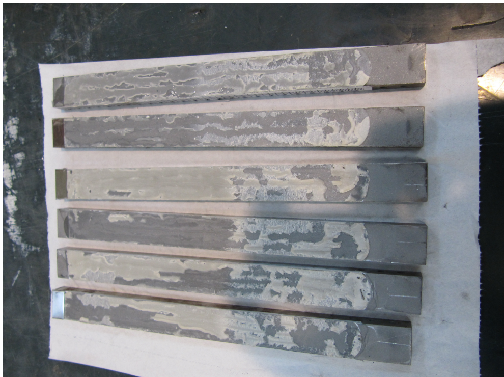
Figura 39 – Roturas coesivas no adesivo 2015
