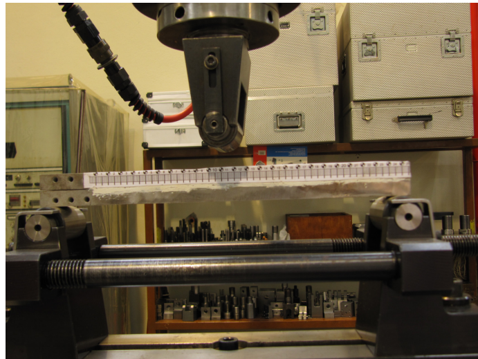
Figura 25 – Provede ENF colocado na MTS para ensaio
