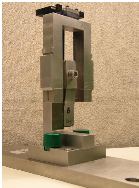
Figura 5 - Provete e suporte para ensaio Wedge Peel em máquina de impacto por queda livre [5]
