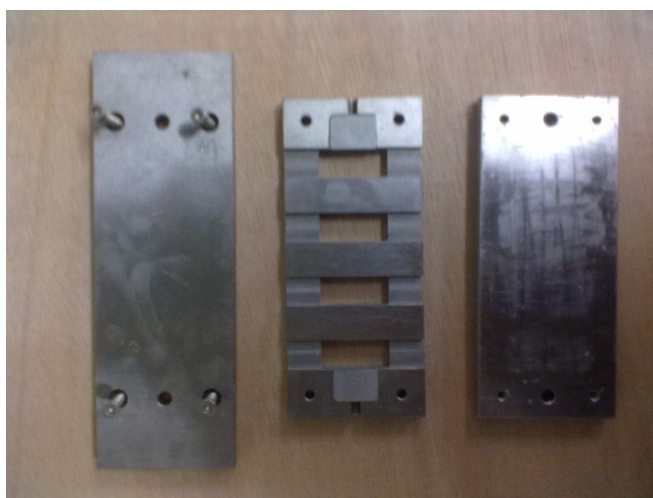
Figura 24: Molde usado no fabrico dos provetes.
