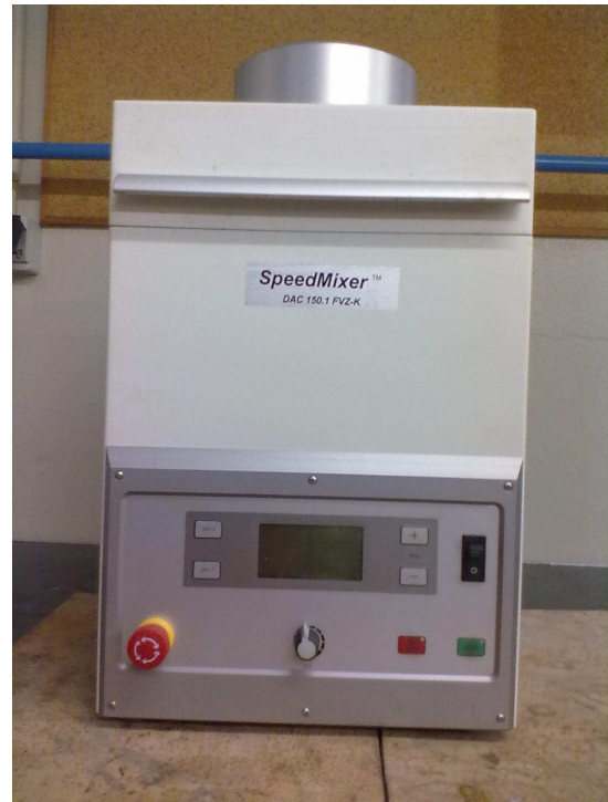
Figura 25: Componentes constituintes do adesivo. Figura 26: Misturadora SpeedMixer DAC 150.1 FVZ-K.
