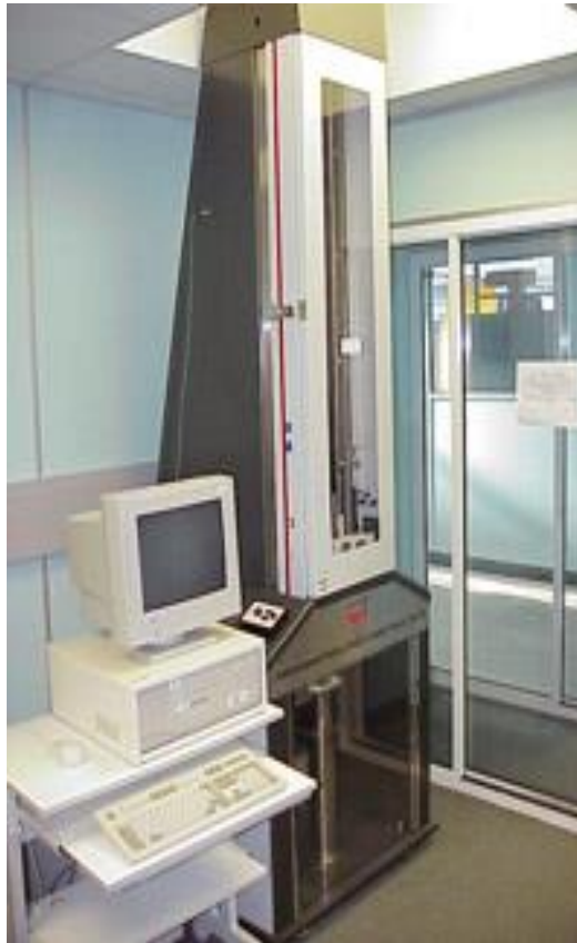
Figura 9 – Máquina de ensaio de impacto Rosand IFW5 [1]
