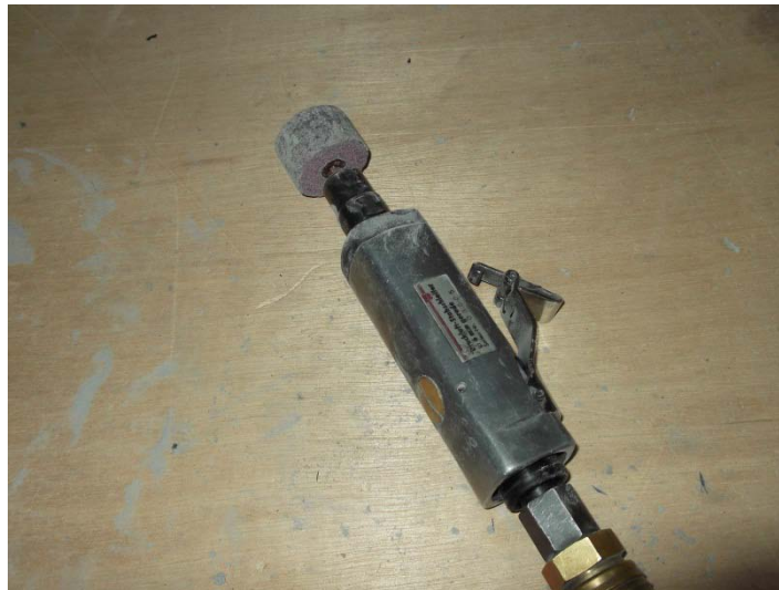
Figura 3.19 - Ferramenta pneumática com mó.
