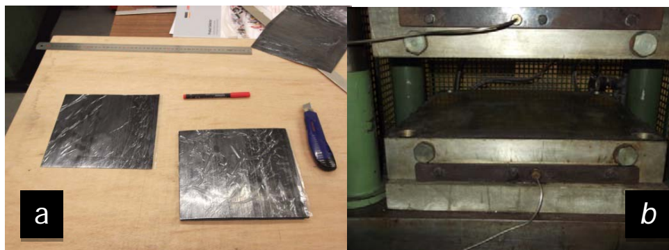
Figura 3.7 - (a) Placas finais cortadas e (b) Interior da prensa pratos quentes.
