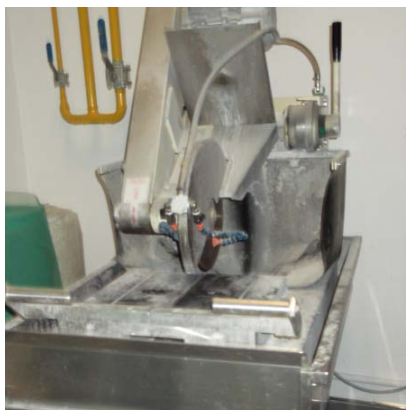
Figura 3.13- Máquina de corte de compósitos.
