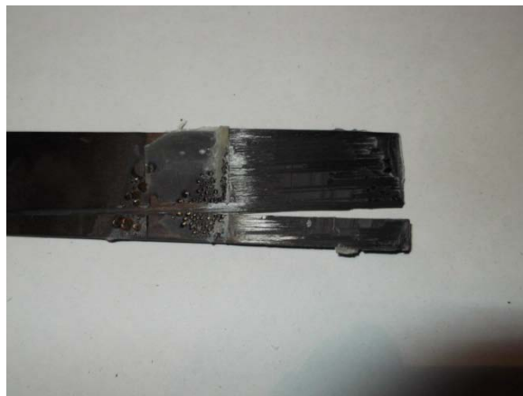
Figura 5.10 - Rotura no compósito da JSS de l_0=30 mm.
