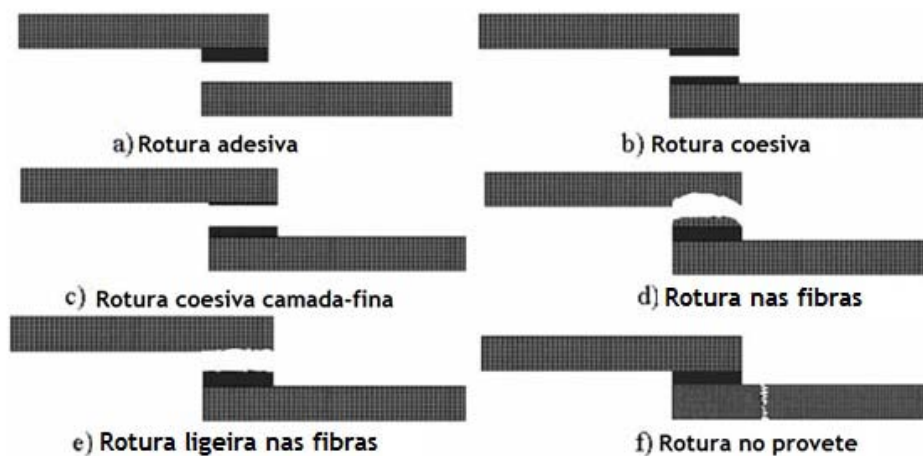
Figura 2.2 - Modos de rotura de JSS em substratos de compósito (Banea et al. 2009).
