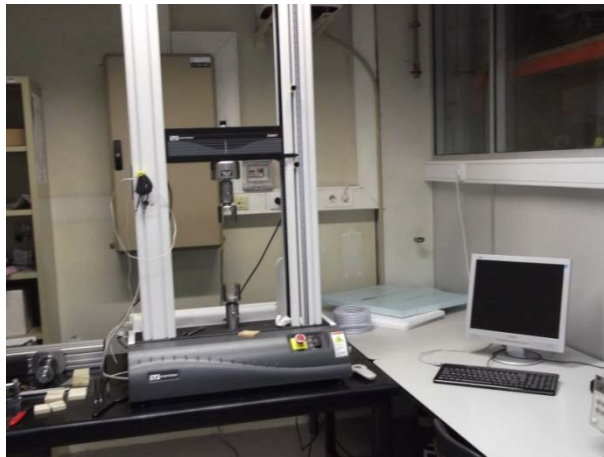
Figura 3.21 - Máquina de ensaios INSTRON.
