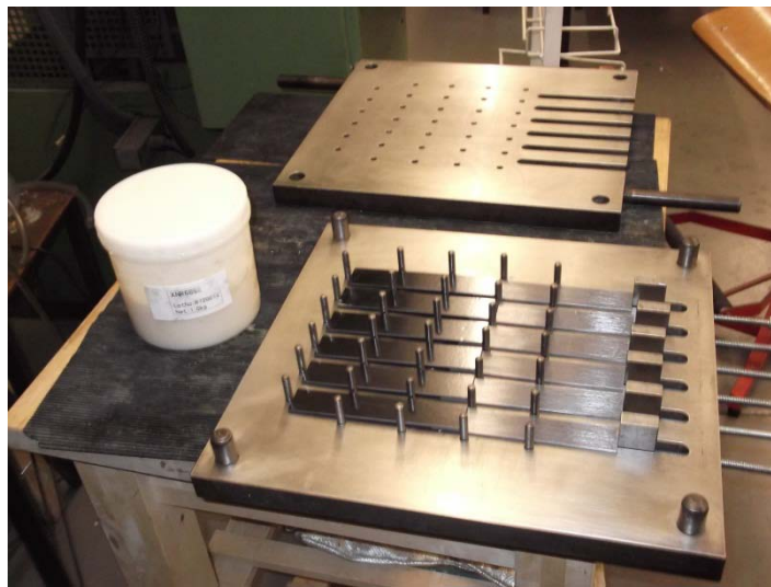
Figura 3.18 - Molde com as JSS do adesivo XNR6852.
