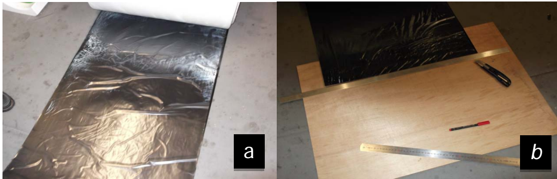
Figura 3.6- (a) Rolo de compósito de CFRP e (b) procedimento de corte das placas
