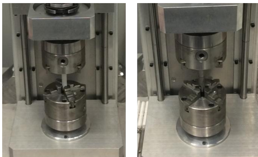
Figura 4.5 - Na imagem da esquerda está representado o provete de PVC e na imagem da direita o provete com o adesivo 3M™ AF 163-2K.
