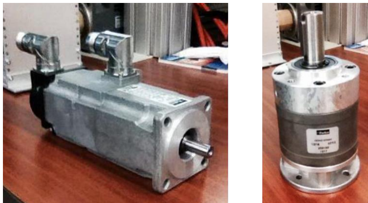
Figura 2.15 - Na imagem à esquerda, servomotor Parvex ® NX 310EAPR7310. Na imagem à direita o redutor planetário Parvex ® GE3N26R0401. Adaptado de (Costa, 2015).
