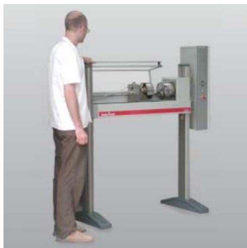
Figura 2.8 - Máquina de ensaios de torção TorsionLine TL020 (Zwick/Roell, 2012).
