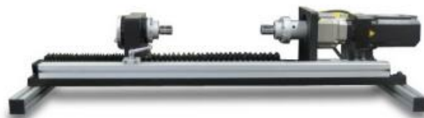
Figura 2.10 - Máquina de ensaios de torção eXpert 9618 (ADMET, 2013).
